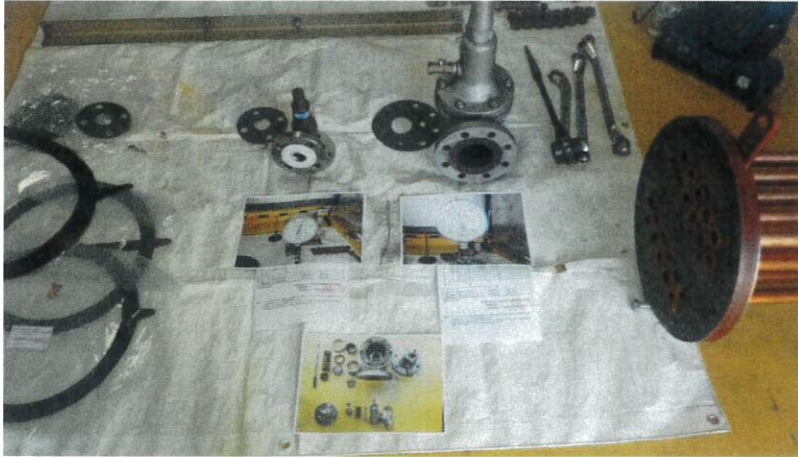
付属設備 安全弁、圧力計温度計
