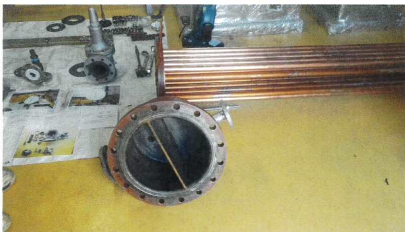
新設蒸気加熱コイル
