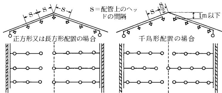
イ ヘッドを取付ける面の傾斜が1分の1（45°）を超えるもので当該屋根又は天井の頂部にヘッドを設ける場合は、次図の要領により当該屋根又は天井とヘッドとの水平離隔距離を60cm以上とすることにより、当該屋根又は天井の頂部からの垂直距離をアによることなく1mを超えて設けることができる。◆
