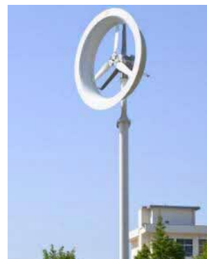
図50. 小型風力発電機（レンズ風車）
