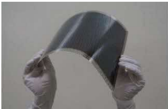
図49. フィルム型ペロブスカイト太陽電池モジュール
