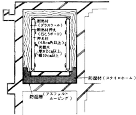
図6-2 冷凍室等断熱処理施工例
