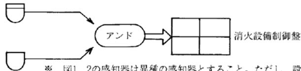
※ 図1, 2の感知器は異種の感知器とすること。ただし、設置場所により同種の感知器を設置する場合は、感度の異なる感知器とすること。
