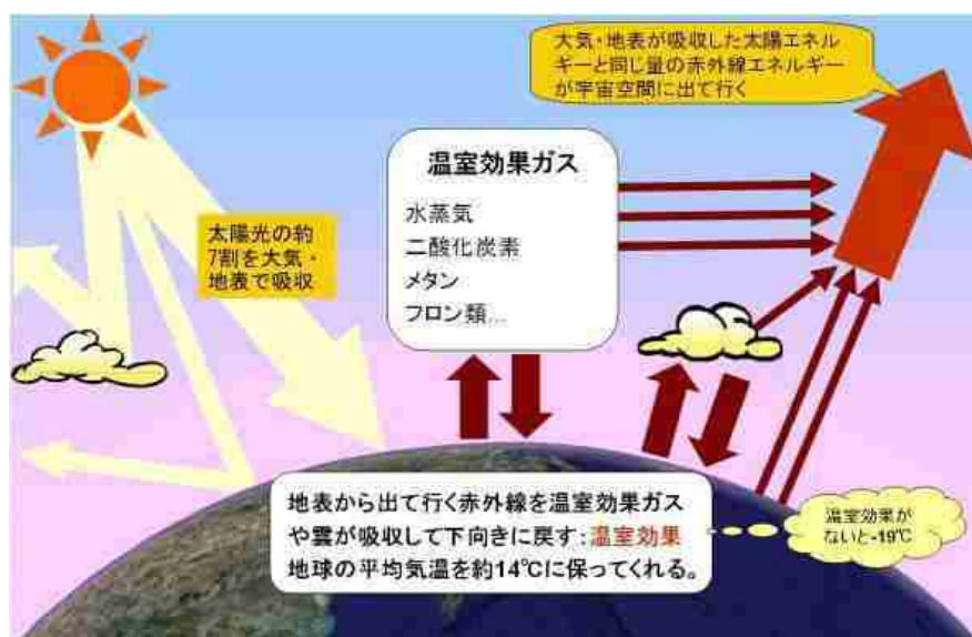
（図IX-1） 温室効果の模式図（気象庁ウェブサイトより）
