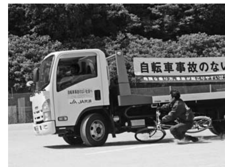
トラックが左折時に、内輪差により、脇を走行中の自転車を左後輪に巻き込む事故の再現。
