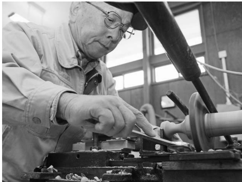
熟練した技術を要する「甘日市ろくろ」と呼ばれる木工ろくろ。けん玉の「血胴（さらどう）」と呼ばれる部分の皿にくぼみを付ける作業。半世紀以上けん玉作りに携わる西村さんは「これほど難しいものはない」と語る。
