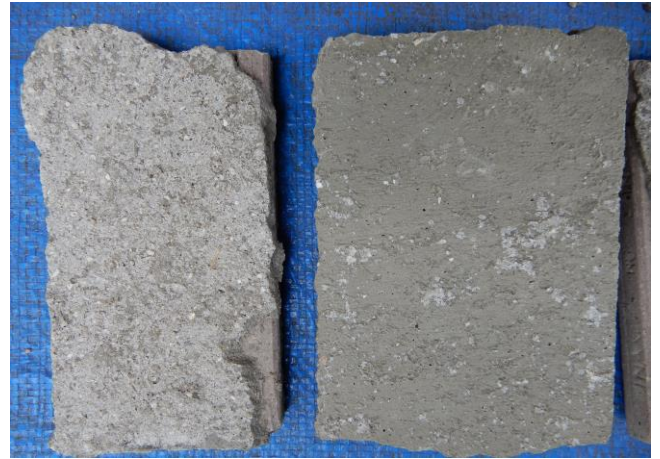
貼付モルタルが裏面に残っており 下地モルタルとの界面ではがれています。
