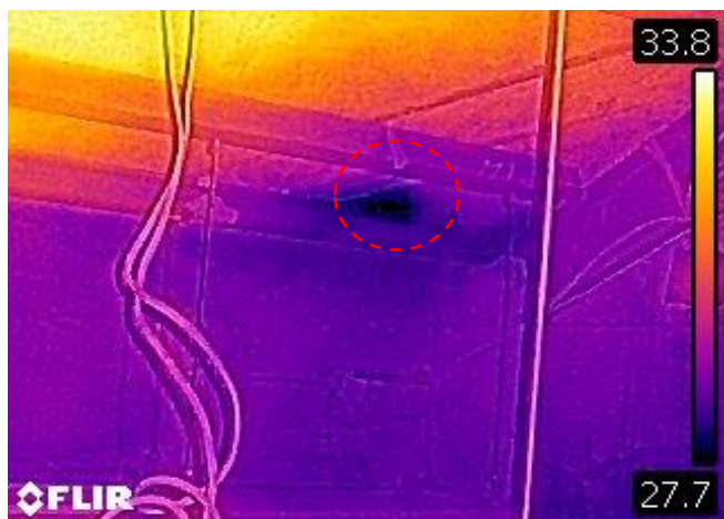
1 1 3 の位置です。 2階倉庫天井裏の様子です。 すき間が見られた箇所にはサーモグラフィック カメラを使用して温度差異を確認しました。
