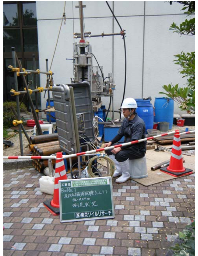
孔内水平載荷試験状況 (GL-4.00m)
