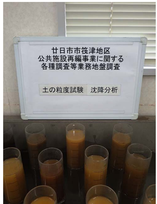
土の粒度試験（沈降分析）
