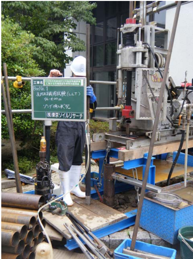
孔内水平載荷試験ゾンデ挿入状況 (GL-4.00m)
