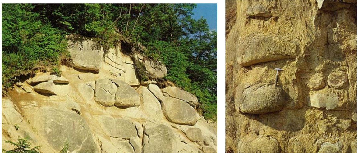
写真-3.1 花崗岩の風化形態 (左：節理沿いの亀裂、右：玉ねぎ状風化)
